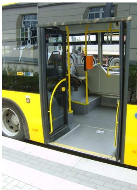
Rys. 7.2. Przerwa między peronem przystankowym a autobusem.
