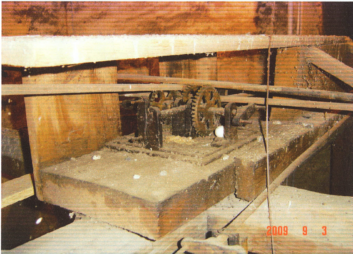
7.18. mechanizm zegara z 1924r,przekładnia na tarcze fot.43
